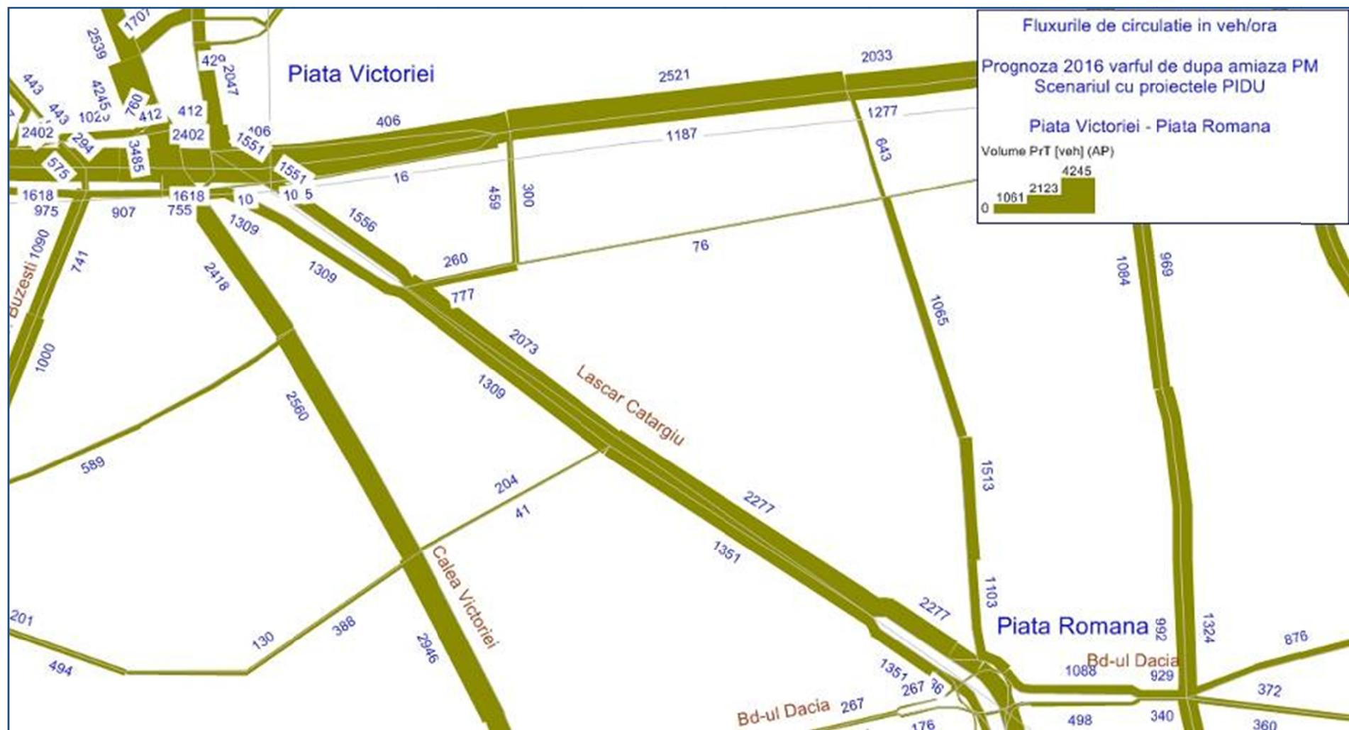
**Figura 84: Fluxurile de circulație în Vehicule/oră, ora de vârf de după amiază PM - București, anul 2016 cu proiectele PIDU - Piața Română**
