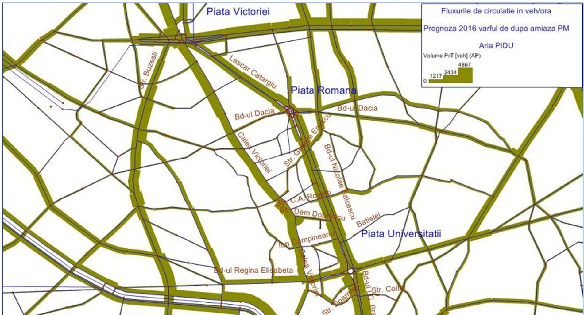
**Figura 59: Fluxurile de circulație în Vehicule/oră, ora de vârf de după amiază PM - București, anul 2016 - Piața Victoriei**
