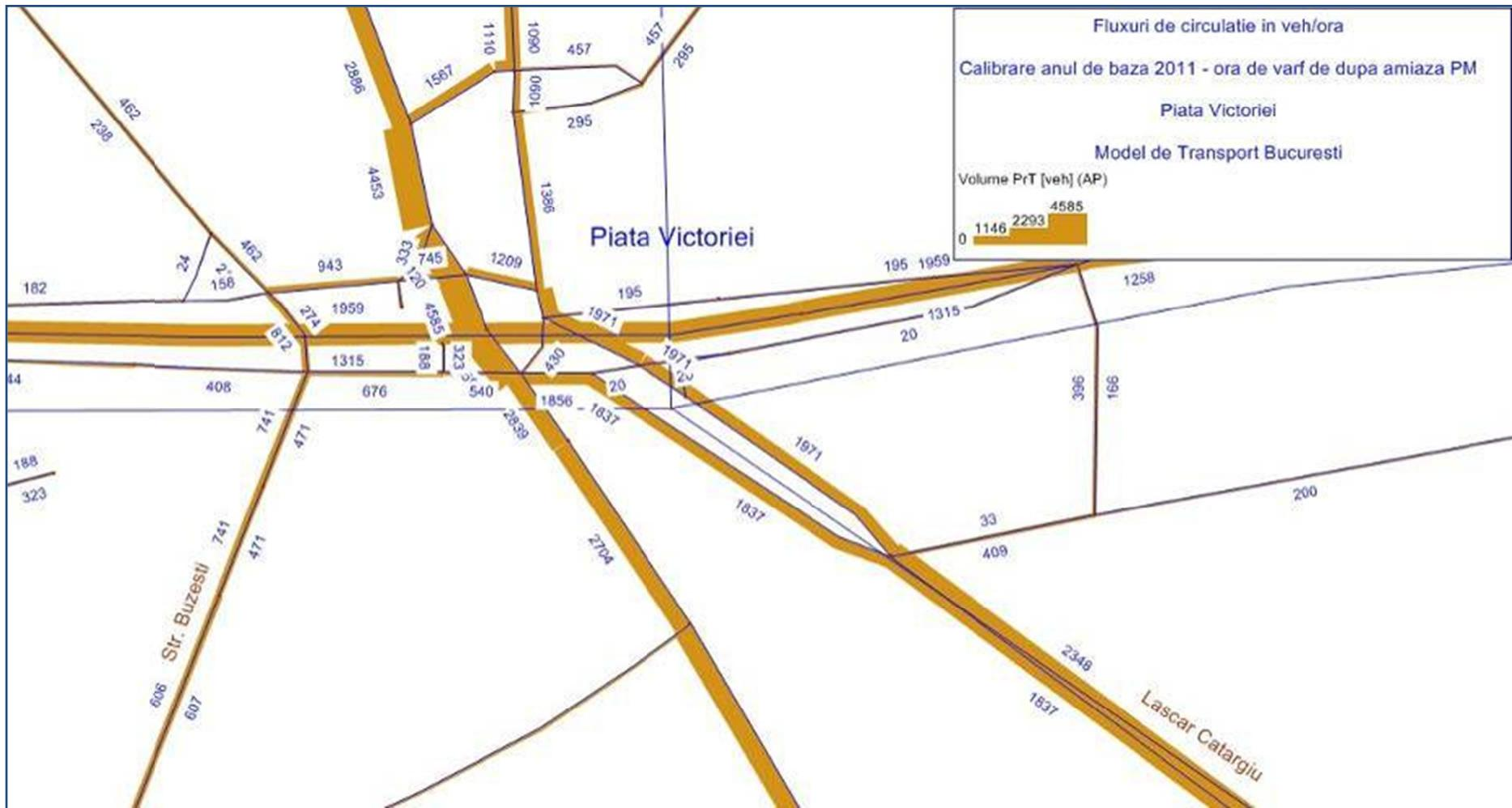
**Figura 30: Fluxurile de circulație în Vehicule/oră, ora de vârf de după amiază PM - București, anul de bază 2011 - Piața Victoriei - Piața Română**
