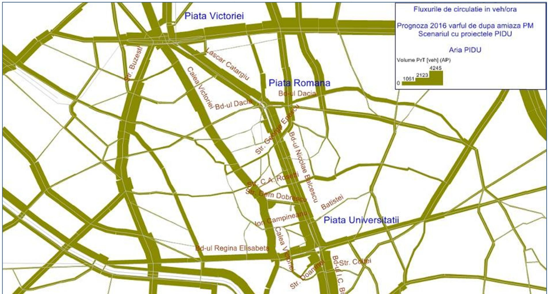
Figura 82: Fluxurile de circulație în Vehicule/oră, ora de vârf de după amiază PM - București, anul 2016 cu proiectele PIDU - Piața Victoriei
