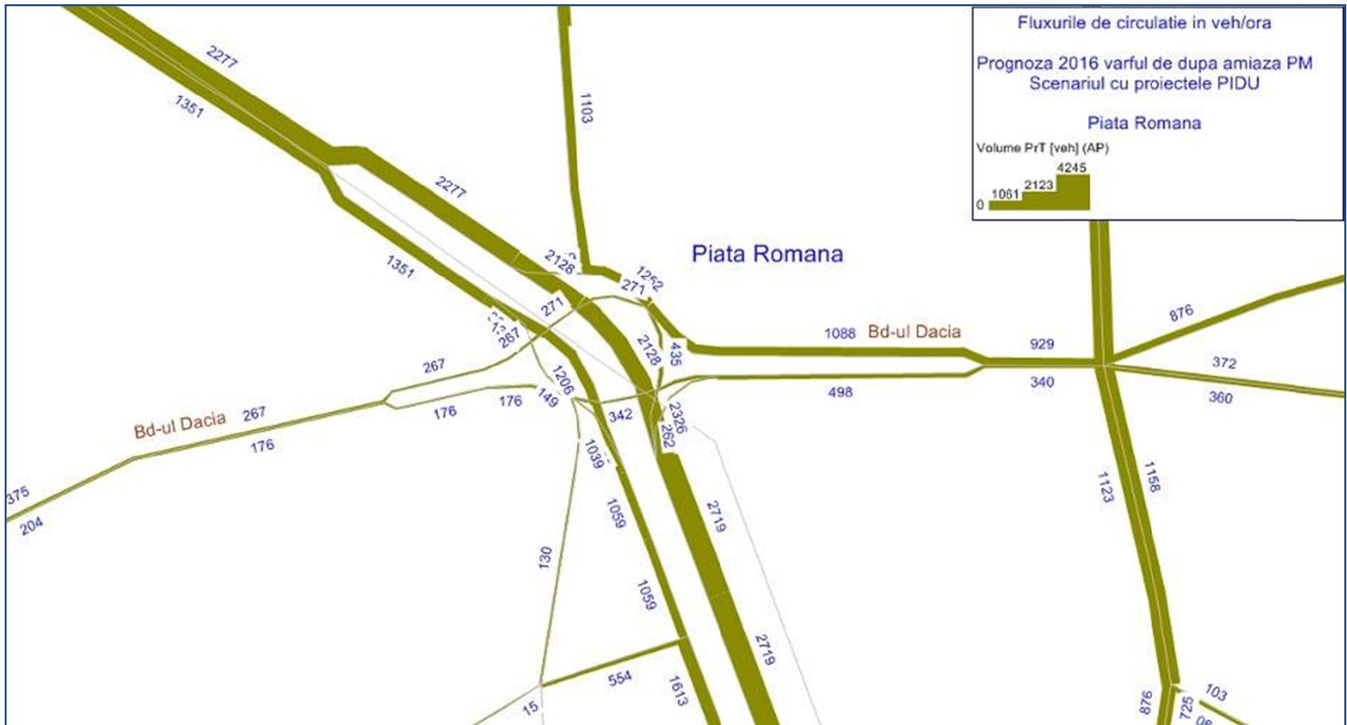
**Figura 85: Fluxurile de circulație în Vehicule/oră, ora de vârf de după amiază PM - București, anul 2016 cu proiectele PIDU
