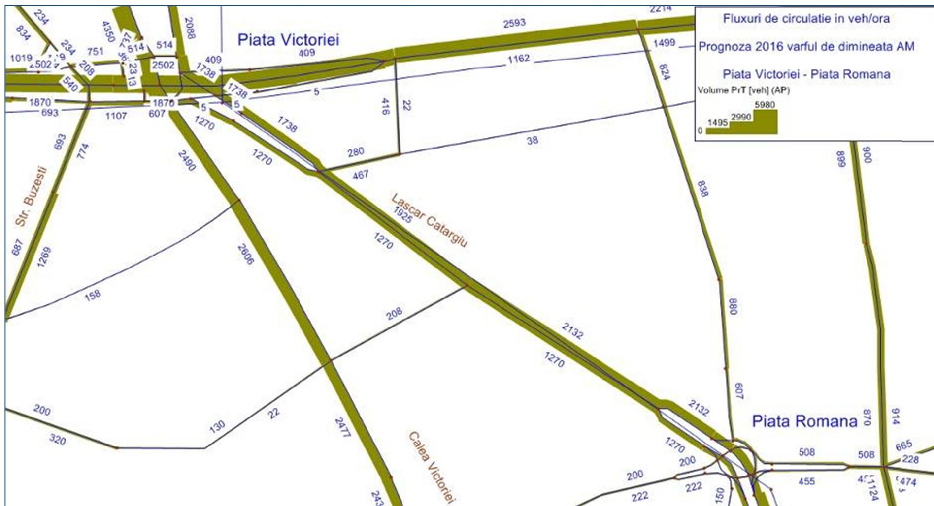
**Figura 50: Fluxurile de circulație în Vehicule/oră, ora de vârf de dimineată AM - București, anul 2016 - Piața Română**
